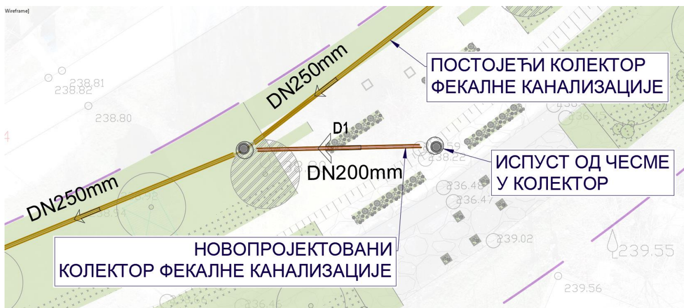
Слика 34 Приказ новопроектваног канализационог колектора
